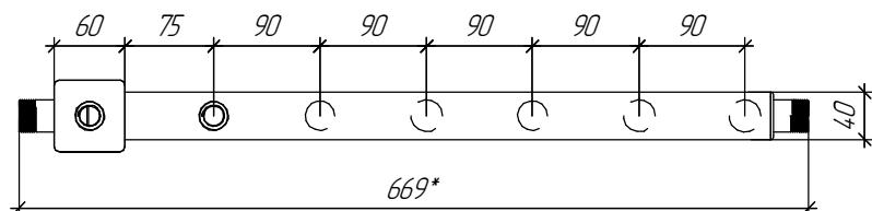
\* Используется для разметки отверстий кронштейнов
